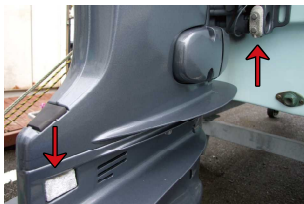
船外機の防食亜鉛(矢印)
