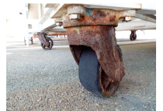
稼働しないと固着します
